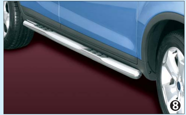
Side bar with step with rubber dots 76mm (with TÜV-certificate) Flankenschutzrohr mit Auftritt und Antirutschnoppen 76mm (mit TÜV-Gutachten)
