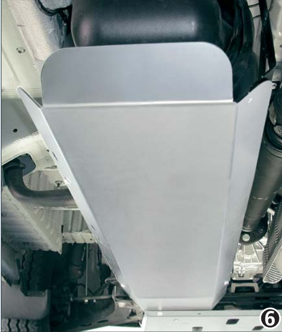
Tank protection plate KR (2933mm) only mountable with 11W5015 Tankschutzblech KR (2933mm) nur montierbar mit 11W5015
