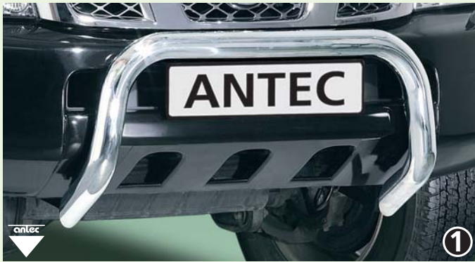
EU-pedestrian protection guard 70mm (EU-certificate also valid in combination with 1374041) EU-Personenschutzbügel 70mm (EU-Zertifikat auch gültig mit 1374041) Stainless steel/ Edelstahl
