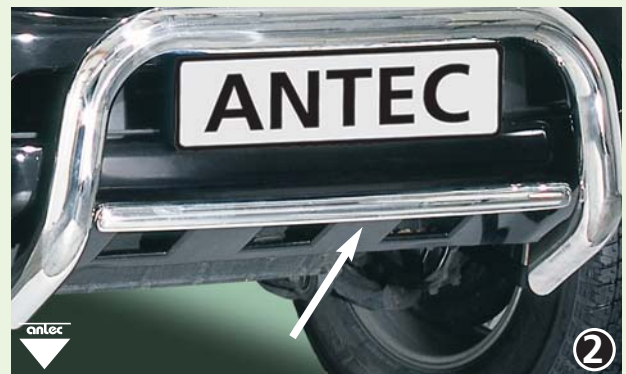
EU-horizontal pipe 42mm (EU-certificate valid in combination with 1374113 only) EU-Querrohr 42mm (EU-Zertifikat nur gültig mit 1374113) Stainless steel/ Edelstahl
